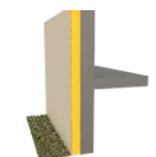
**Ajout d'une isolation thermique par l'extérieur sous enduit : 180 mm de polystyrène expansé + enduit de façade - R = 5.0 m<sup>2</sup>.K/W - Surface isolée = 150 m<sup>2</sup>**
