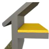
**Remplacement de l'isolation des combles par : 280 mm de ouate de cellulose soufflée - R = 7.1 m<sup>2</sup>.K/W - Surface isolée = 55 m<sup>2</sup>**
